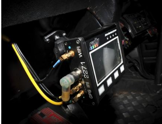
Bild 3: Standardinstallation Gerät+Antenne in klarer / ungehinderter Sicht
